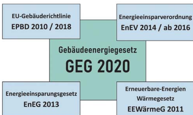
Abb. 1: Energiesparrechtliche Regelungen, die das Gebäudeenergiegesetz GEG 2020 vereint. Quelle: Melita Tuschinski: Energieausweise für die Praxis
